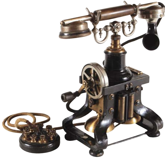
Ericson marka, çatal tip, tüm aksamı dışarıda 1882 model masa telefonu (PTT Genel Müdürlüğü, Sirkeci PTT Müzesi)
