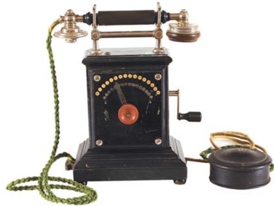
Vingers Elec. Wasted Kristiaina marka çatal manyetolu A-15 kanallı masa telefonu (PTT Genel Müdürlüğü, Sirkeci PTT Müzesi)
