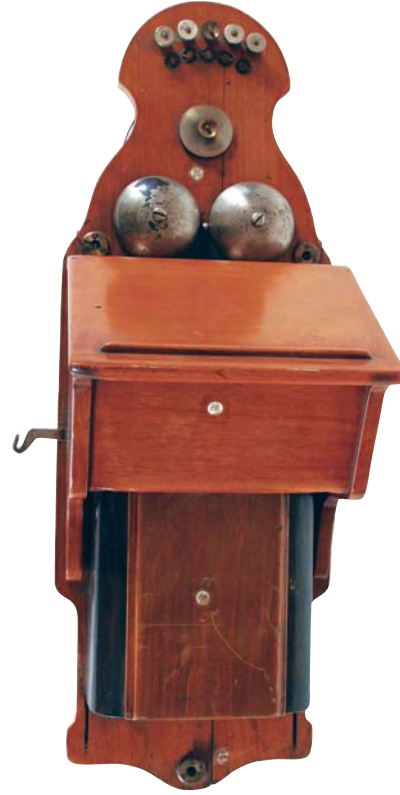
Manyetolu çift zilli, üzerinde ahizesi olan ahşap duvar telefonu (PTT Genel Müdürlüğü, Sirkeci PTT Müzesi)
